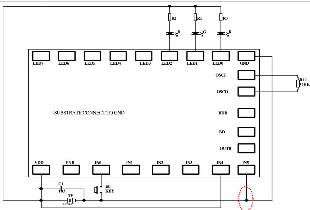
注：IN5 接 GND 上電進入 SLEEP。IN5 接 VDD 上電工作。
